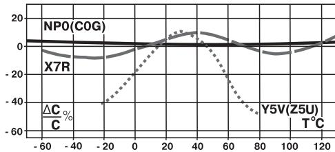
**NPO(COG)** - используется в прецизионных цепях, в рабочем диапазоне емкость практически не зависит от температуры, времени, напряжения и частоты.  $TKE = 0 \pm 30 \cdot 10^{-6} 1 / ^\circ C$ .
